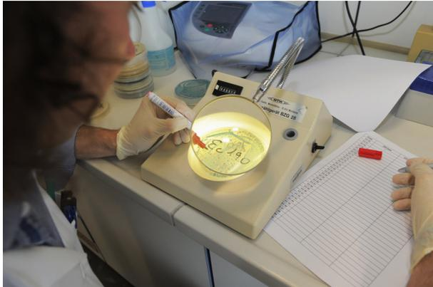
**Abb. 1:** BfR-Mitarbeiter beim Auszählen von *E. coli*-Kolonien auf Nährboden mit Lebensmittelprobe
