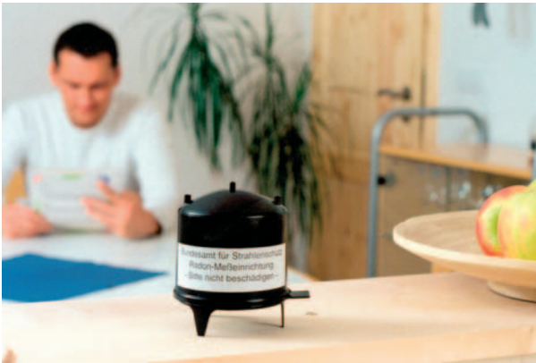
Exposimeter zur Messung der Radon-Konzentration bis zu einem Jahr. Es kann auch in einem offenen Bücherregal aufgestellt werden.
