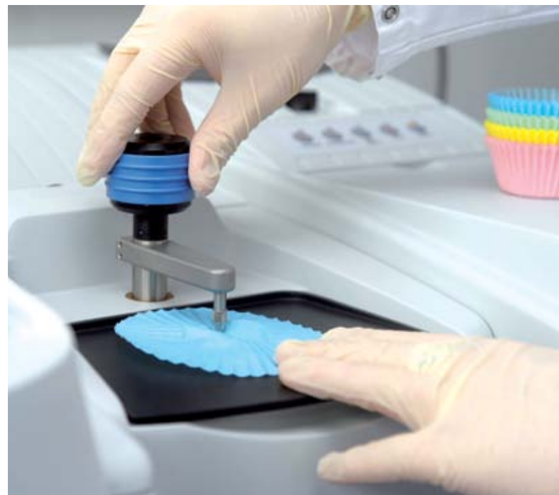
Mittels Infrarot-Spektroskopie (FT-IR) wird in Muffinbackförmchen nach Fluorverbindungen gesucht. Muffin cups are analysed for fluoro compounds with infrared-spectroscopy (FT-IR).
